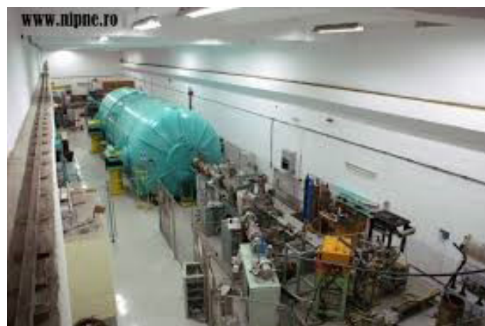
Фиг.3. 9 MV Тандем ускорител в ИФИН-XX. Виждат се детайли от инсталацията на йонния източник
